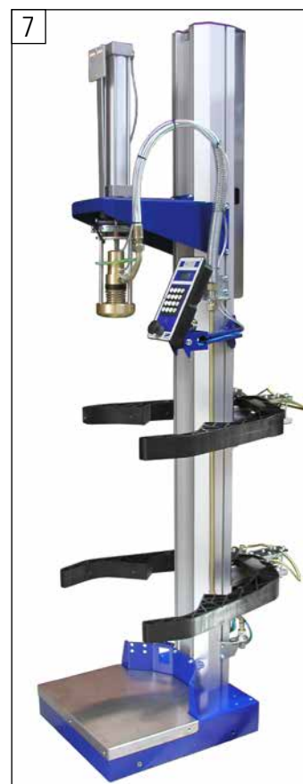
Poste d'emplissage universel UFM avec dispositif de centrage double pour emplissage automatique de bouteilles industrielles munies de vannes centrales
